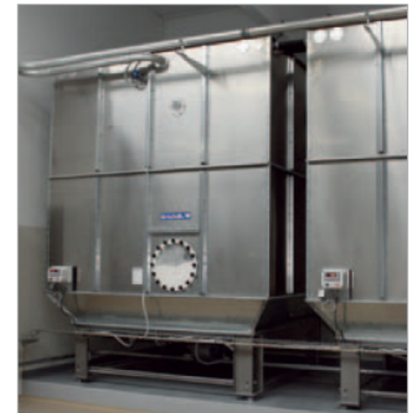
Mehlsilos in Aluminiumausführung mit Fließbetaustragung Messzellen zur Siloverwiegung
