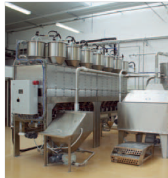
Zutatenautomat Compo4000 mit Befüllung über Sackeinschüttstation Sackeinschüttstation für Schrotmehl Zentralabsaugung
