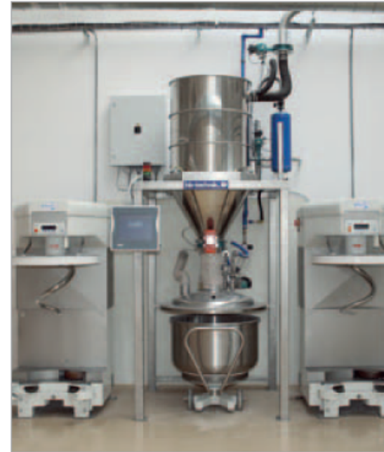
Behälterwaage BWI 150 kg mit Staubabsaughaube Rezeptcomputer hb-backcontrol Wasserdosierung
